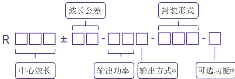
\*输出方式：F - 光纤耦合输出
